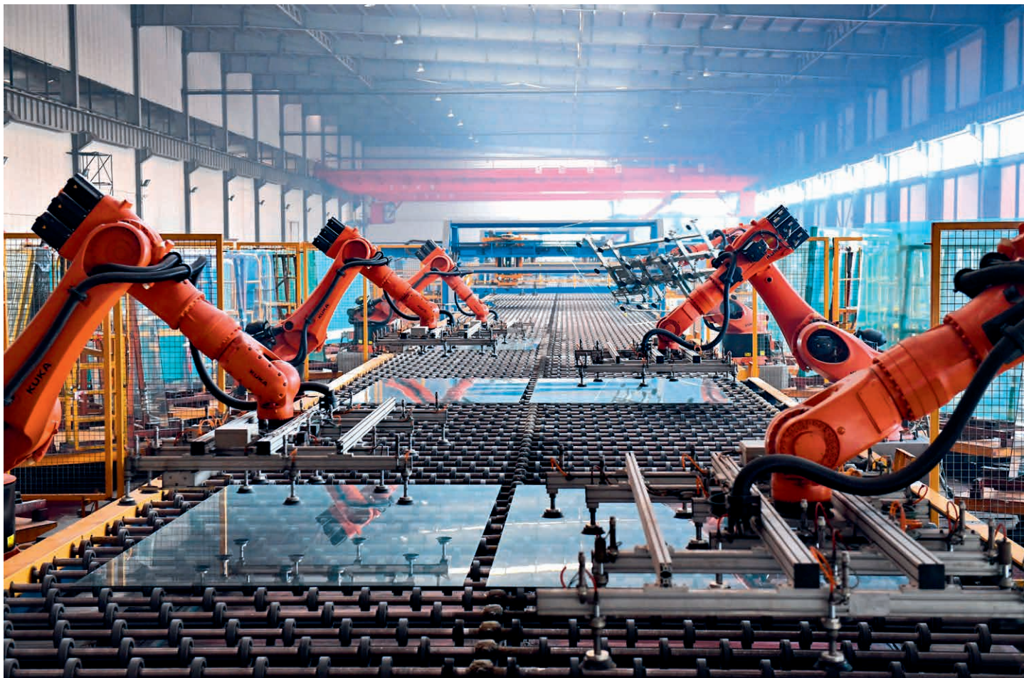
Низ технолошких напредних аутоматизованих линија за производњу флоат стакла које је изградило предузеће у провинцији Хебеи
